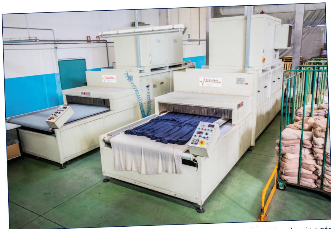
*Impianto di asciugatura a nastro radiofrequenza, impiegato per l'asciugatura di calze e collant*
