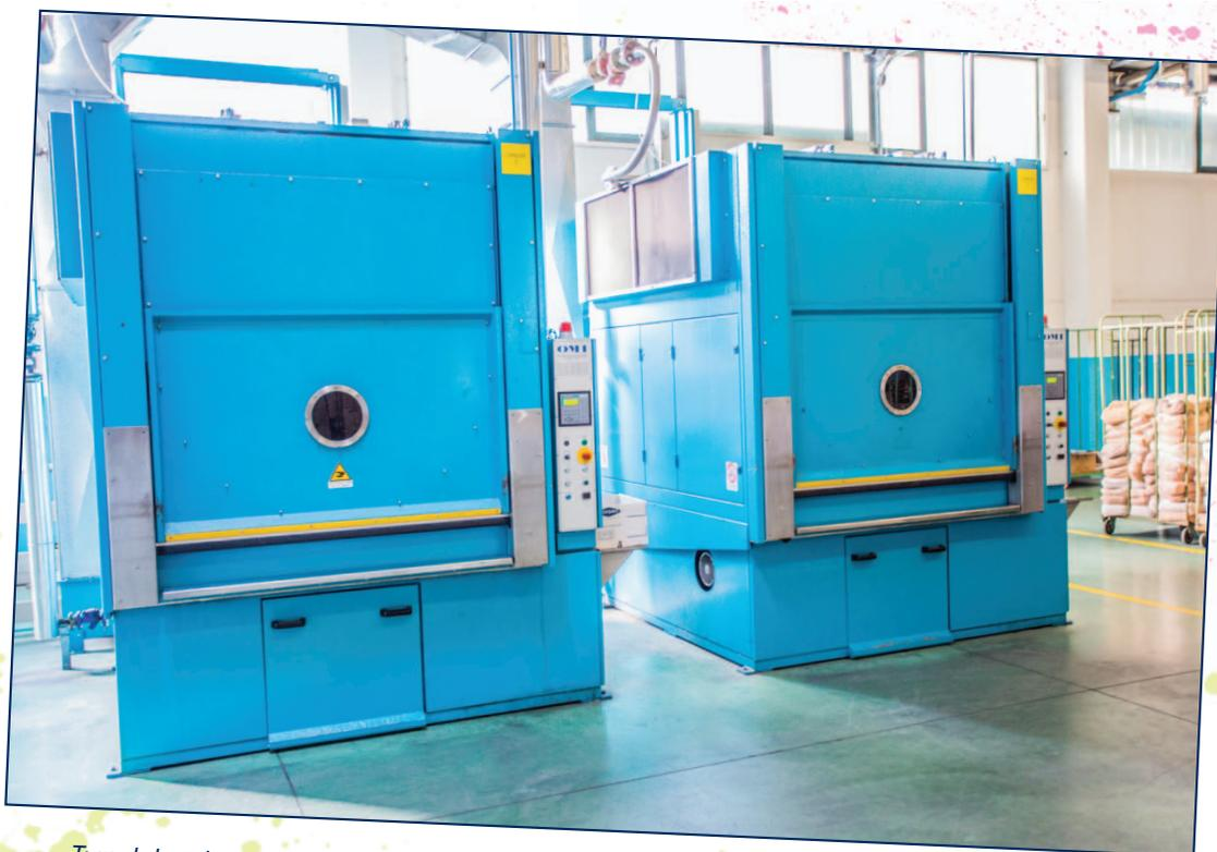
*Tumbler, impiegato per l'intimo e alcune tipologie di calze e collant che richiedono il processo di asciugatura ad aria*
